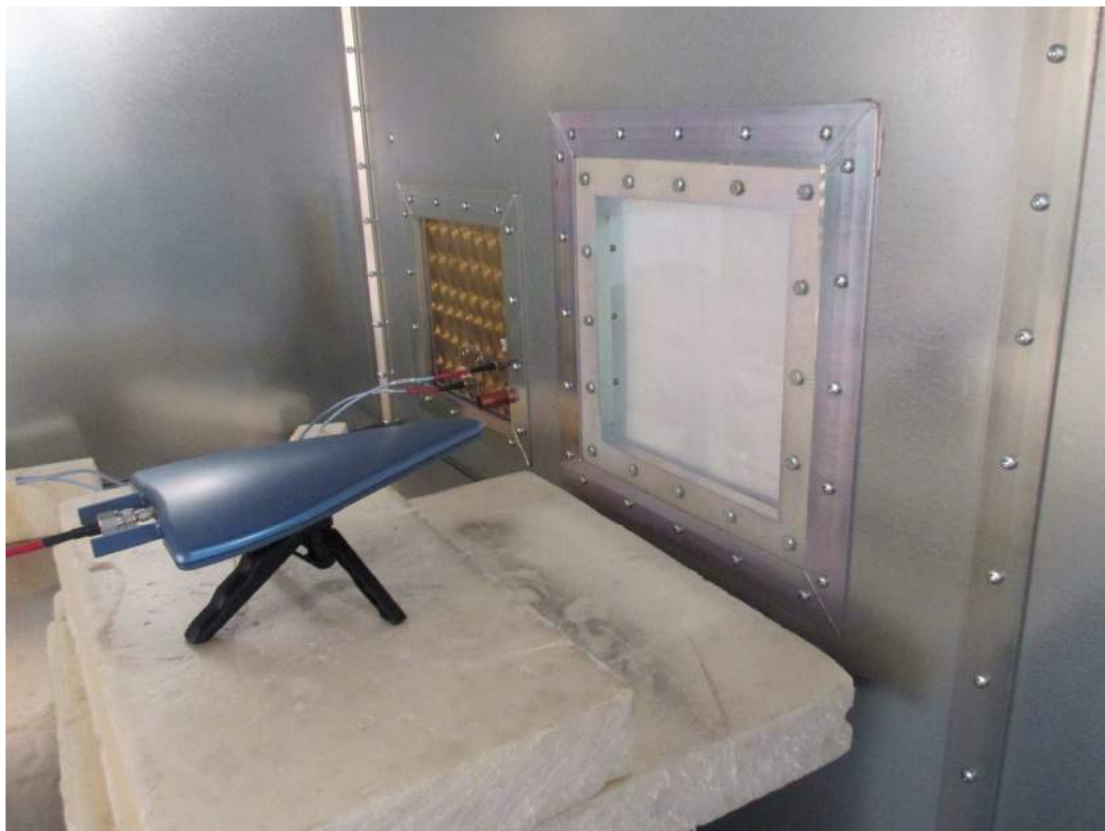
Mesure d'atténuation du tissu (Vue intérieure)
